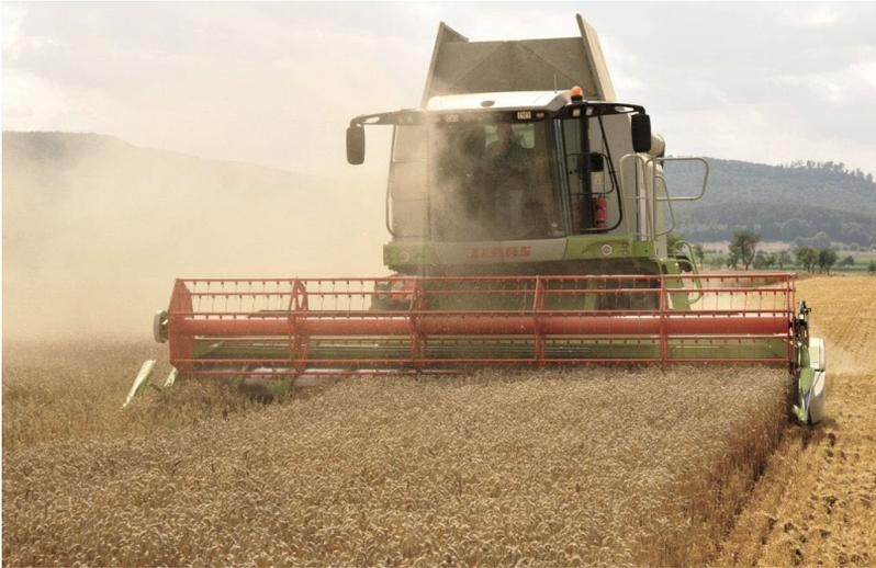
Ein Mähdrescher klatscht superreife, zerbrechliche Gerste mit einem Schaufelrad in eine große Schale. Weil die Gerste so spröde ist, zerbricht der Samenkopf, und auch das Korn wird weitgehend von der Spreu getrennt. Der Mähdrescher führt dann eine Kombination von Operationen aus (deshalb heißt er auch Mähdrescher). Dazu gehört das Trennen der Saat von der Spreu.
